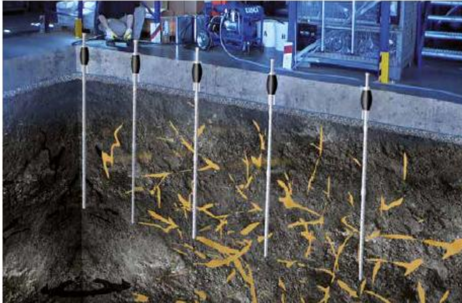
Obr.2 – schéma clonové injektáže pod nosnou konstrukcí
